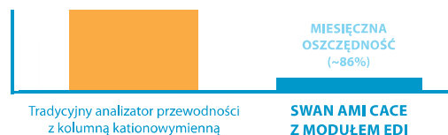
Rys. 3. Oszczędność wynikająca z zastosowania SWAN AMI CACE w stosunku do konwencjonalnego analizatora z klasyczną kolumną kationowymienną (dla pH=9,7 i przepływu=8l/h).
